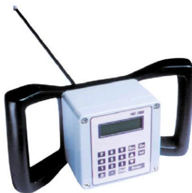
FIGURA 14. Penetrômetro utilizado para determinar a resistência do solo à penetração
