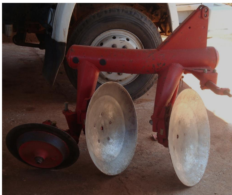
FIGURA 4. Arado fixo utilizado para o preparo convencional do solo
