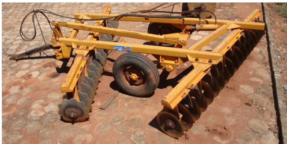
FIGURA 5. Grade “off-set” utilizada para o preparo convencional do solo
