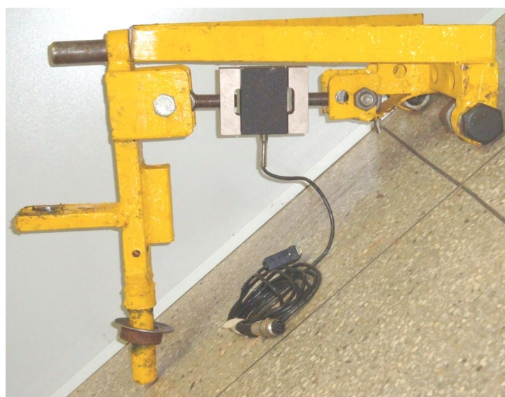
FIGURA 12. Estrutura de adaptação desenvolvida para instalação da célula de carga entre o trator e a semeadora-adubadora
