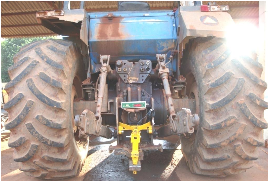
FIGURA 13. Estrutura de adaptação desenvolvida para instalação da célula de carga entre o trator e a semeadora-adubadora em cor amarela, instalada no trator utilizado no experimento
