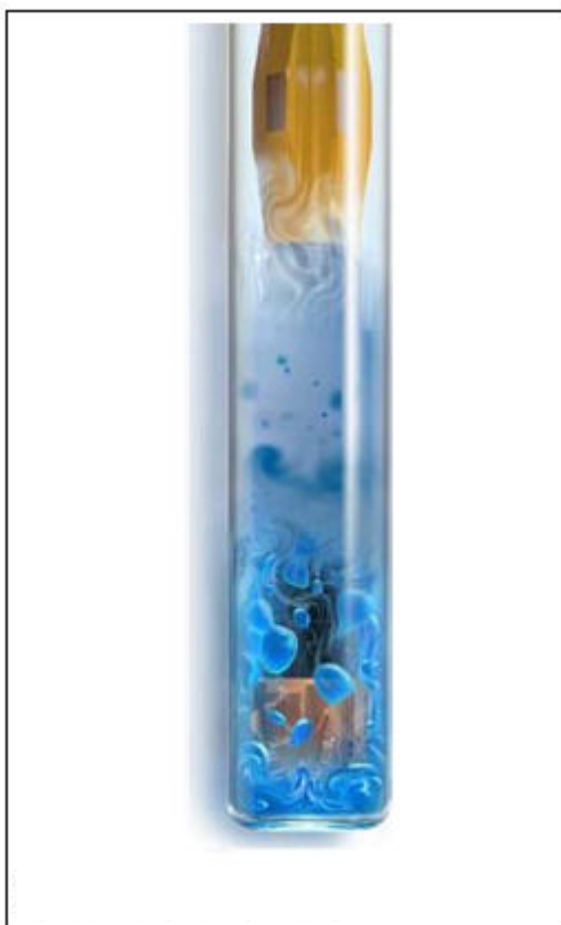
Figura 3 – Representação visual da formação da “névoa”, com aquecimento a uma temperatura acima da temperatura do ponto de névoa (adaptado de PALEOLOGOS, 2005).
