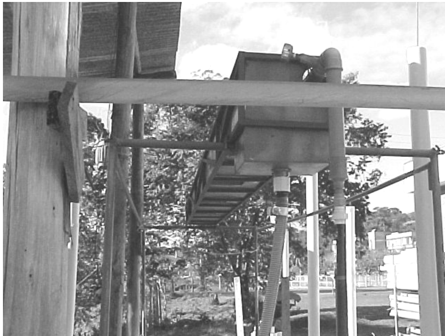
Figura 16. Simulador de chuvas utilizado no experimento.
