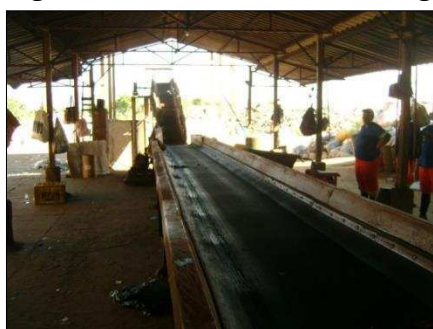
Figura 24. Esteira rolante de triagem da IRR de Manhuaçu
