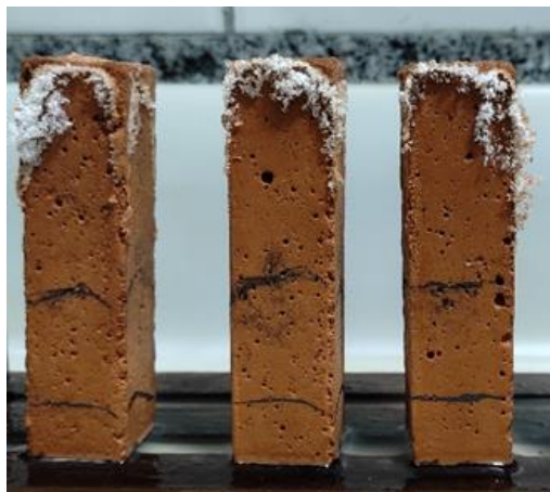
Figura 4.16 – Degradação da matriz por eflorescência
