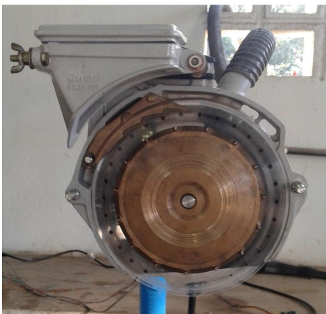
Figura 5 – Mecanismo dosador de sementes equipado com disco de acrílico
