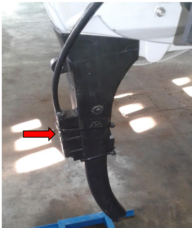
Figura 9 – Sensor óptico instalado no tubo condutor de sementes
