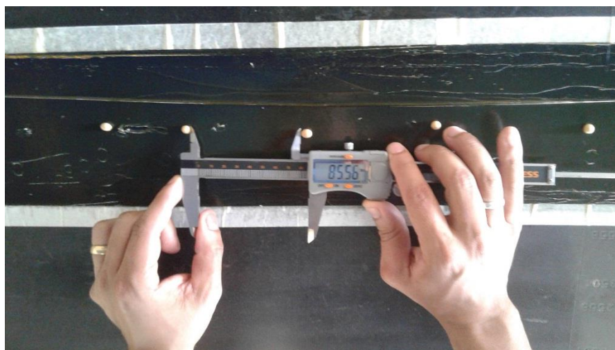
Figura 8 – Mensuração manual dos espaçamentos entre sementes com paquímetro digital
