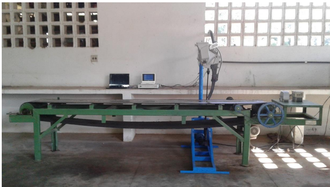
Figura 3 – Bancada para ensaios de semeadura em laboratório
