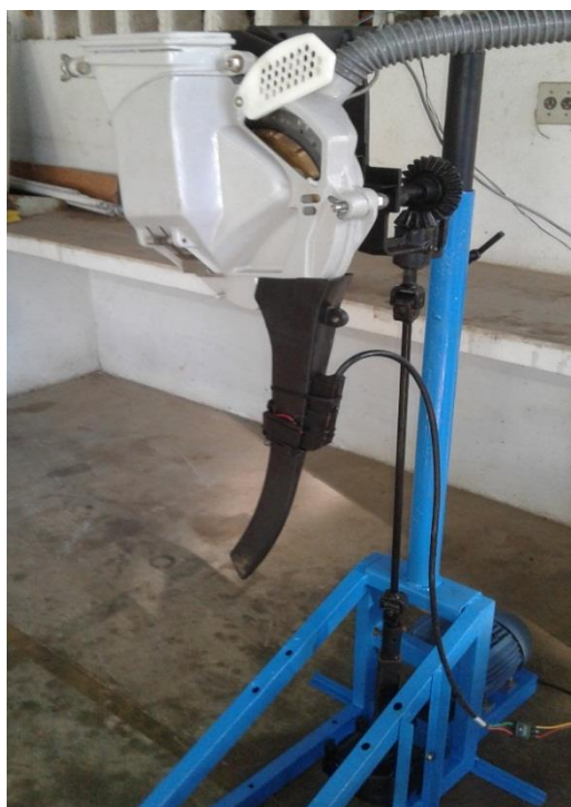
Figura 4 – Estrutura suporte com o mecanismo dosador de sementes e sistema de transmissão de velocidade
