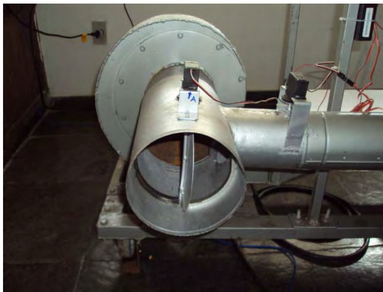
Figura 5.37 – Posicionamento da válvula de entrada de ar para um ângulo de abertura igual a 0°C
