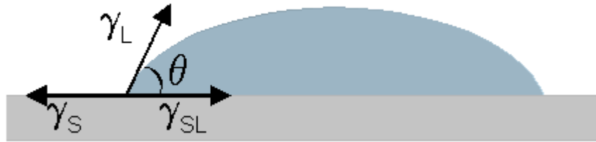
Figura 1 Ângulo de contato ( \theta ) entre uma gota líquida e uma superfície plana e horizontal. As tensões superficiais da superfície do sólido \gamma_s , do líquido \gamma_L e superfície/líquido \gamma_{SL} . Imagem extraída de Van Loosdrecht et al., (1987).
