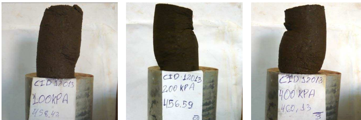
Figura 35- Detalhes dos corpos-de-prova após ruptura para a Mistura 2 – Energia do Proctor Intermediário
