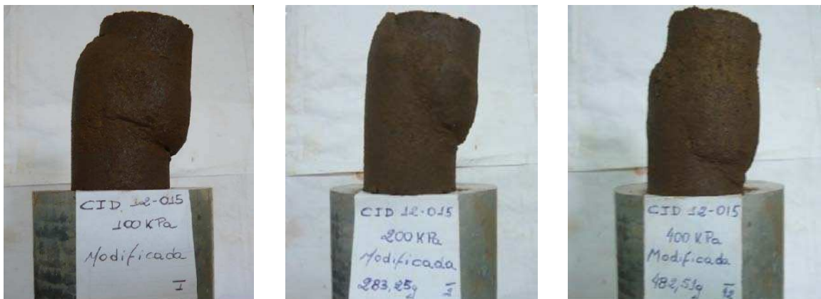
Figura 51 – Corpos-de-prova após ruptura para a Mistura 3 – Energia do Proctor modificado
