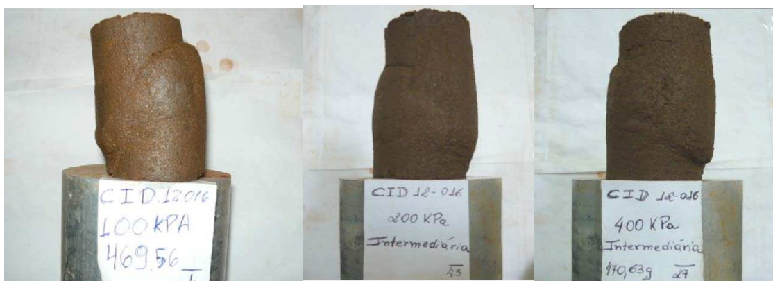
Figura 39 – Corpos-de-prova após ruptura para a Mistura 3 – Energia do Proctor intermediário (40 % Rejeito + 30 % Escória + 30 % Cascalho)
