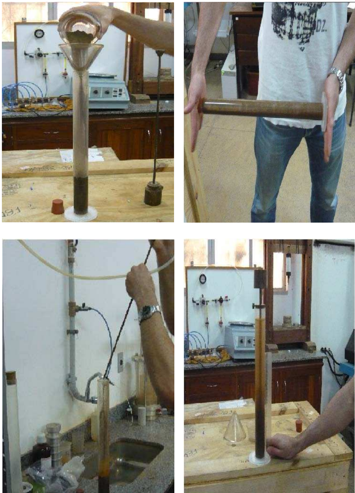
Figura 20 – Detalhe do ensaio de Equivalente de areia
