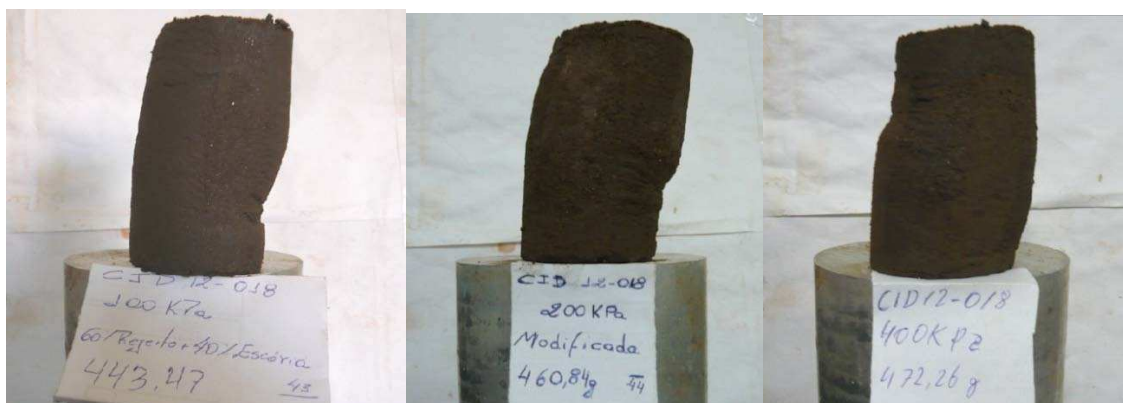
Figura 47 – Corpos-de-prova após ruptura para a Mistura 2 - Energia do Proctor Modificado
