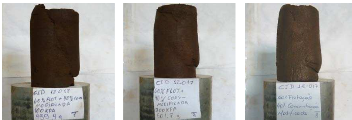
Figura 43 – Corpos-de-prova após ruptura para a Mistura 1 – Energia do Proctor modificado
