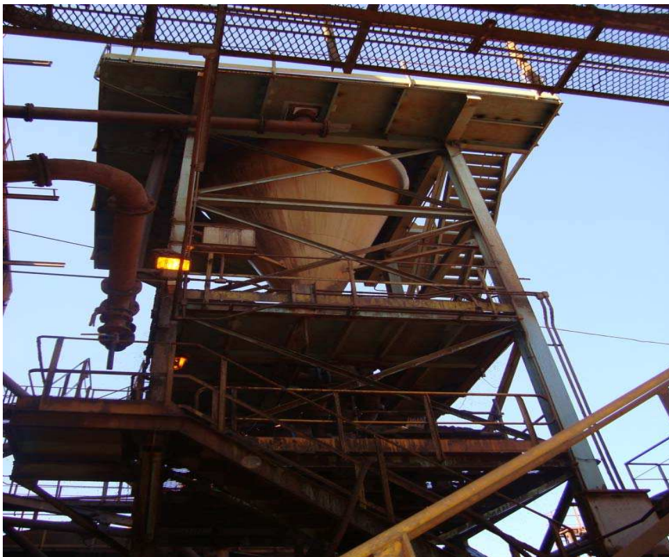
Figura 13 - Ponto de coleta do rejeito de concentração magnética
