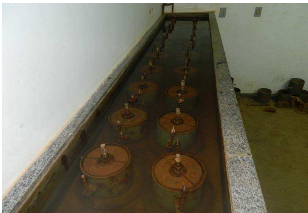
Figura 18 – Corpos-de-prova compactados e imersos em água durante 4 dias, em atendimento ao ensaio de CBR
