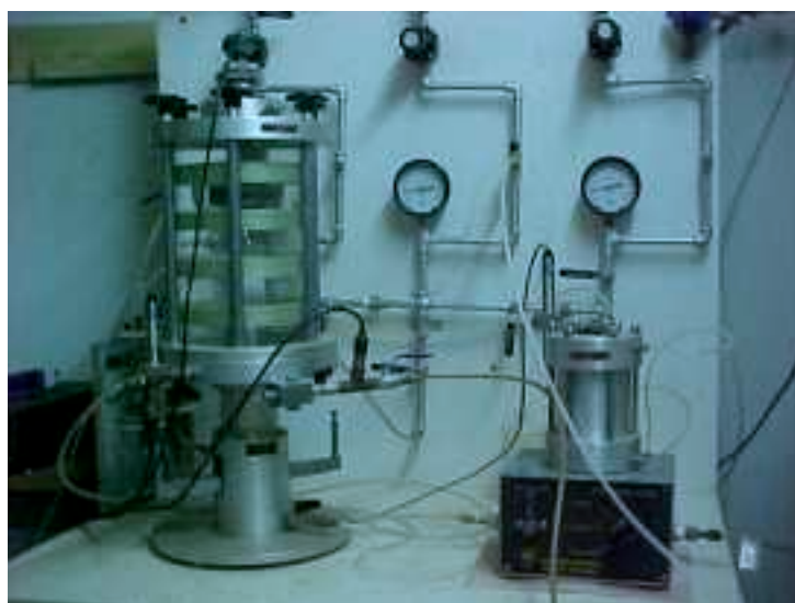
Figura 2 – Equipamento Triaxial de Tensão Controlada da UFV
