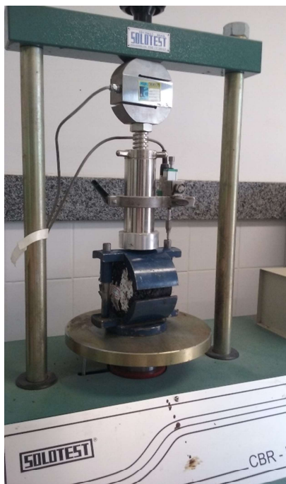
Figura 8 – Equipamento utilizado para a realização dos ensaios de estabilidade e fluência Marshall.
