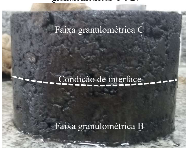
Figura 1 – Corpo de prova moldado no compactador Marshall nas faixas granulométricas C e B.
