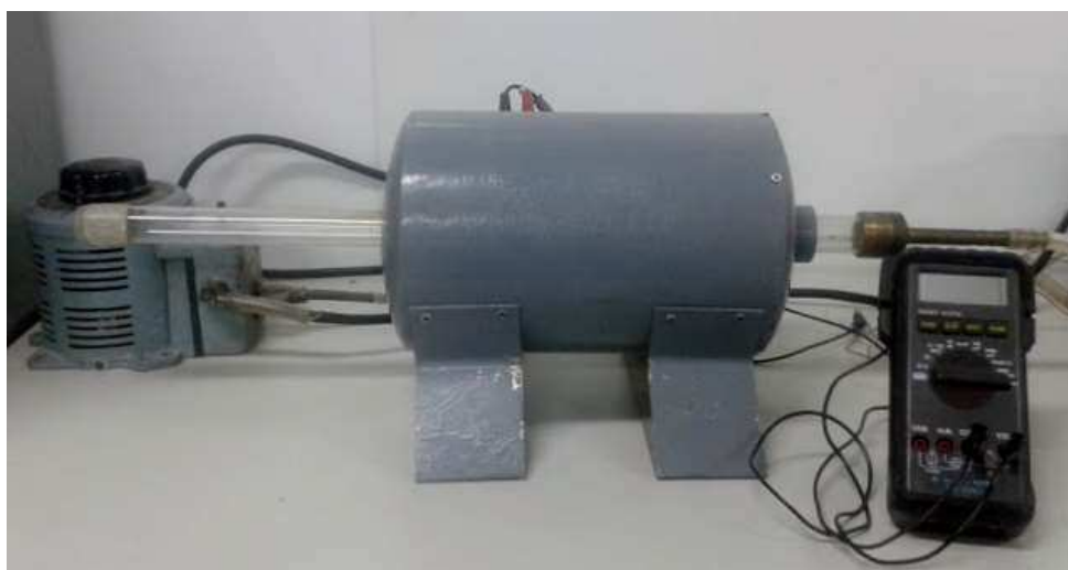
Figura 2.5- Forno utilizado para o tratamento térmico dos nanocompósitos ZnO/CNT.
