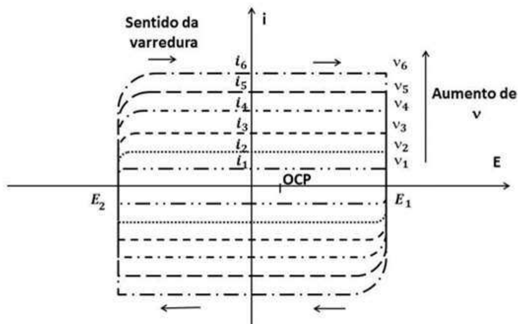
Figura 1.11- Voltametria Cíclica com diferentes velocidades de varredura para análise da capacitância de um eletrodo.
