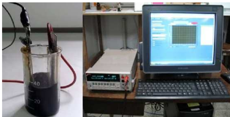
Figura 2.2- Montagem utilizada para EPD de Nanotubos de Carbono: a) célula de EPD; b) fonte de tensão conectada ao software.
