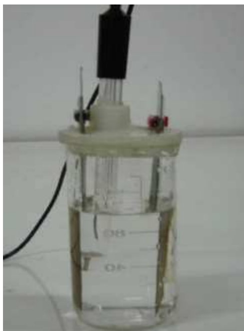
Figura 2.3- Célula eletroquímica utilizada nos experimentos.
