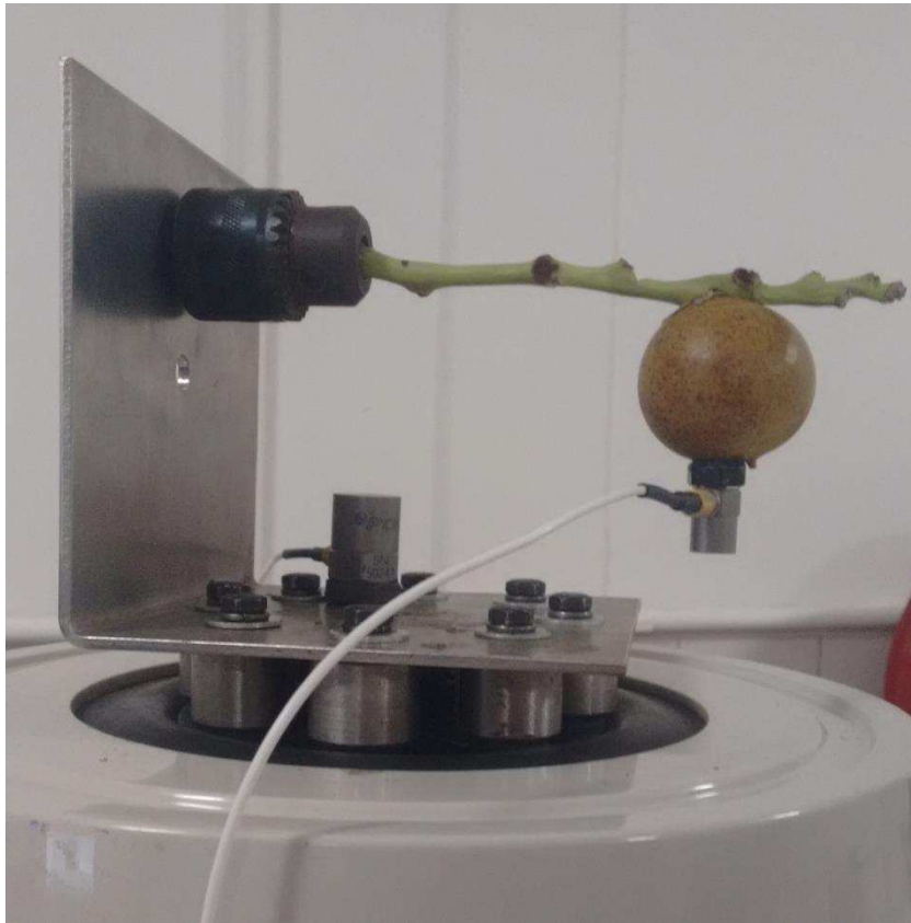
Figura 2.6: sistema fruto-ráquila engastado ao suporte fixado à base móvel do vibrador eletromagnético com acelerômetro fixado verticalmente ao fruto.
