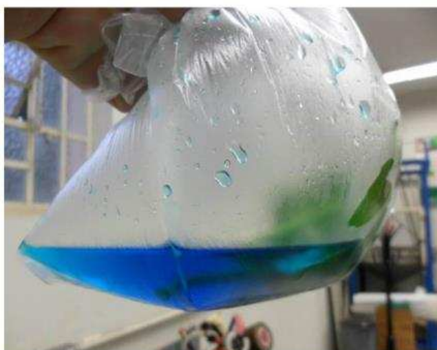
Figura 4. Procedimento de lavagem das folhas com água destilada para extração do traçador azul brilhante.
