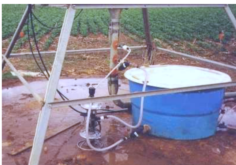
Figura 2 - Detalhe da bomba injetora de defensivo e da caixa de pré-mistura.
