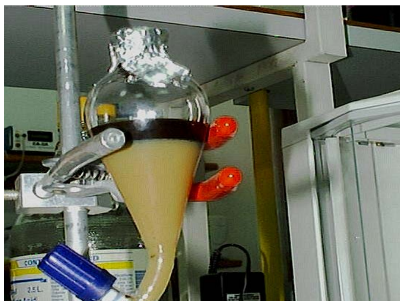
Figura 7. Separação de fases (óleo/água) após a quebra da emulsão pela adição de nitrato de magnésio.
