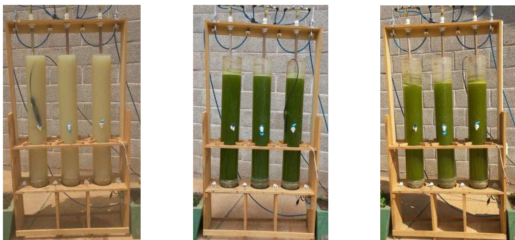
Figura 19. Coloração do meio de cultivo durante a terceira operação respectivamente após 5 horas ( t_1 ), 53 ( t_2 ) e 125 horas ( t_3 ) de operação.
