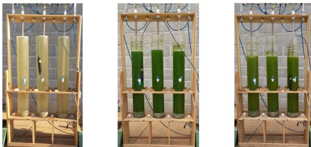
Figura 21. Coloração do meio de cultivo durante a quinta operação respectivamente após 3,5 ( t_1 ), 99,5 ( t_2 ) e 147,5 horas ( t_3 ) de operação.
