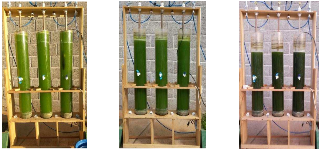
Figura 18. Coloração do meio de cultivo durante a segunda operação respectivamente após 5 horas ( t_1 ), 53 ( t_2 ) e 125 horas ( t_3 ) de operação.
