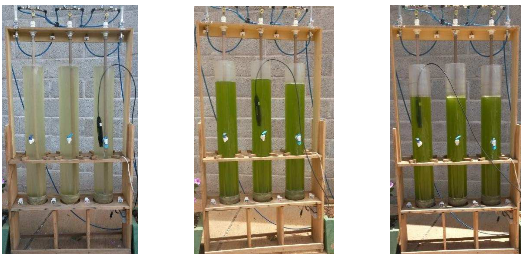
Figura 22. Coloração do meio de cultivo durante a sexta operação respectivamente após 3,5 ( t_1 ), 75,5 ( t_2 ) e 123,5 horas ( t_3 ) de operação.
