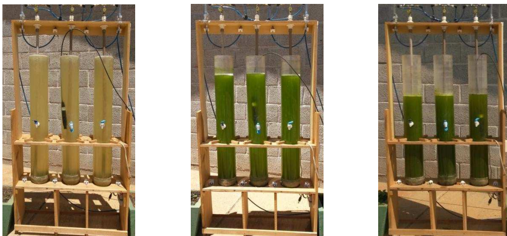
Figura 20. Coloração do meio de cultivo durante a quarta operação respectivamente após 5 horas ( t_1 ), 77 ( t_2 ) e 173 horas ( t_3 ) de operação.
