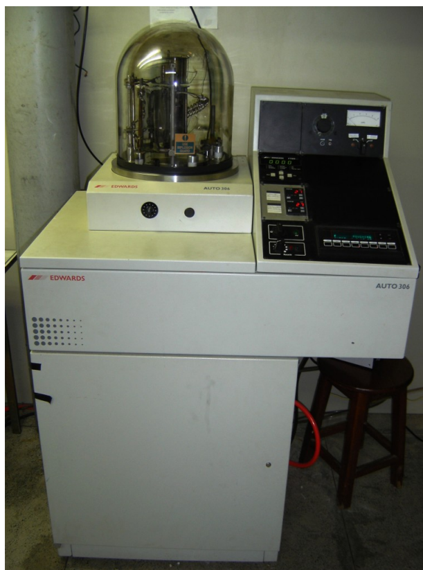
Figura 3.4: Sistema de crescimento HWE e evaporadora.
