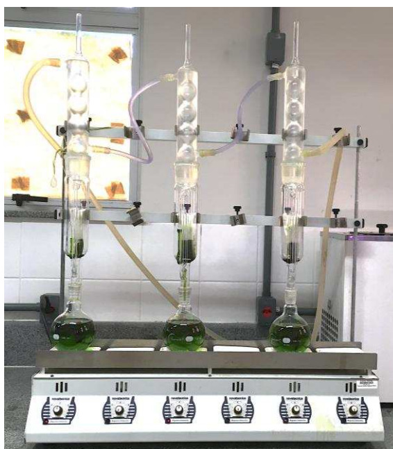
Figura 4 – Extração do óleo bruto de Desmodesmus communis BR007 em extrator do tipo Soxhlet.
