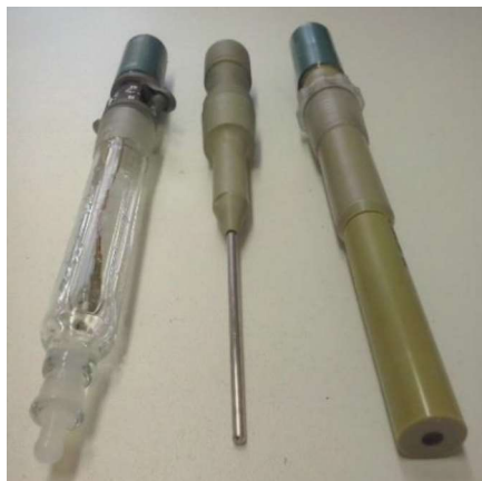
Figura 9. Eletrodo de referência, eletrodo auxiliar ou contra eletrodo e eletrodo de trabalho respectivamente.
