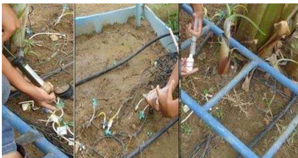
Figura 4- Extração da solução do solo por meio da sucção e coleta da solução do solo.
