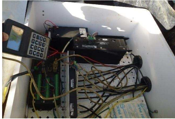
Figura 6- Vista do equipamento usado na determinação do teor de água nos solos.
