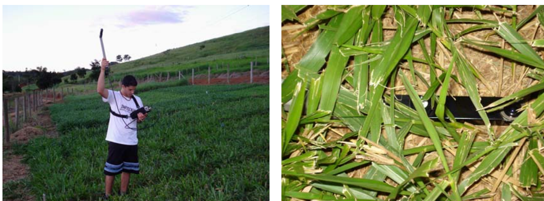
Figura 22 - Determinação da intercepção luminosa, índice de área e ângulo da folhagem utilizando-se o aparelho marca LI-COR® modelo LAI 2000.
