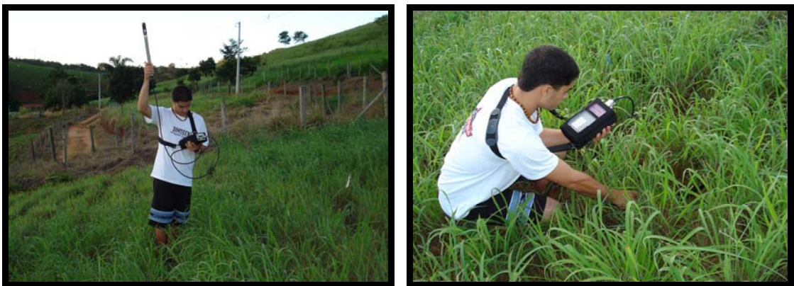
Figura 5 - Determinação da interceptação luminosa, índice de área e ângulo da folhagem utilizando-se o aparelho marca LI-COR® modelo LAI 2000.
