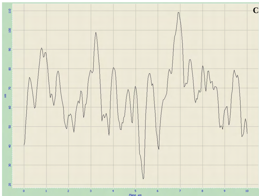
Figura 37: Imagem de MFA para o gel 7. Vistas tridimensional (A) e superficial (B) de área de varredura de (10 \times 10) \mu\text{m}^2 . Perfil de topografia (C) correspondente à linha traçada na vista superficial (B). CONTINUAÇÃO.
