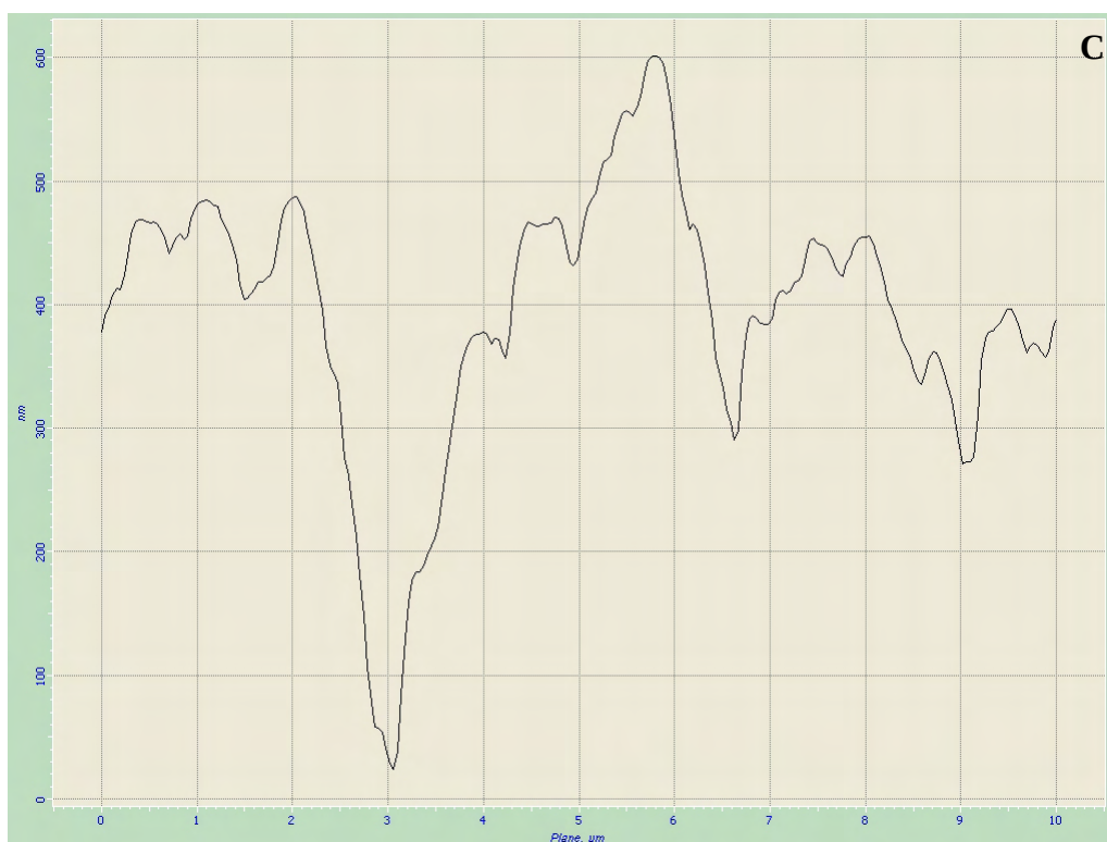
Figura 36: Imagem de MFA para o gel 6. Vistas tridimensional (A) e superficial (B) de área de varredura de (10 \times 10) \mu\text{m}^2 . Perfil de topografia (C) correspondente à linha traçada na vista superficial (B). CONTINUAÇÃO.
