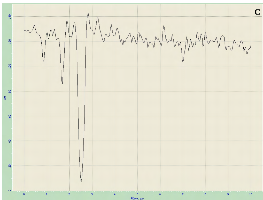
Figura 31: Imagem de MFA para o gel 1. Vistas tridimensional (A) e superficial (B) de área de varredura de (10 \times 10) \mu\text{m}^2 . Perfil de topografia (C) correspondente à linha traçada na vista superficial (B). CONTINUAÇÃO.
