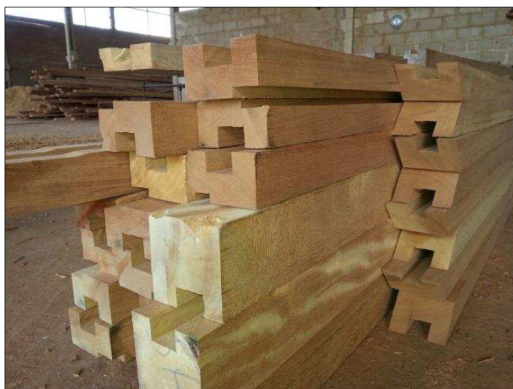
Figura 42 – Batentes de esquadrias com abertura para encaixe das peças de paredes. Fonte: Autor.
