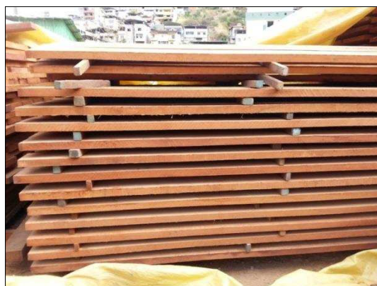
Figura 26 – Madeiras armazenadas com espaçadores entre as peças na empresa C. Fonte: Autor.
