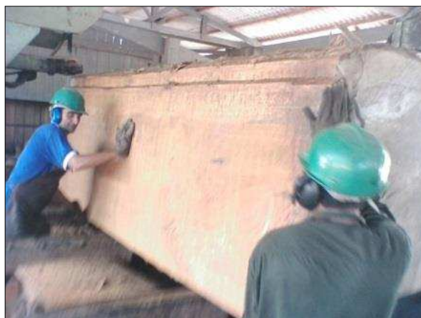
Figura 9 – Desdobro das toras em madeira numa serraria com serra fita.
