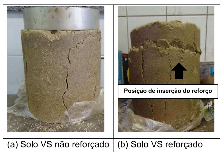
Figura 26 – Planos de ruptura de ensaio RCNC para corpos de prova de solo VS.
