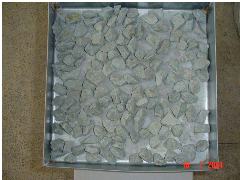
Figuras 6.16: Rocha Básica ao final do ensaio de ciclagem acelerada em etilenoglicol.
