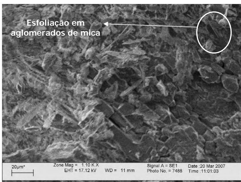
Figura 6.9: Amostra de filito após 100 ciclos no ensaio de ciclagem água-estufa. É possível observar a presença de inúmeros minerais com hábito planar (micas), descoladas da matriz rochosa. Alguns aglomerados de mica mostram esfoliação.
