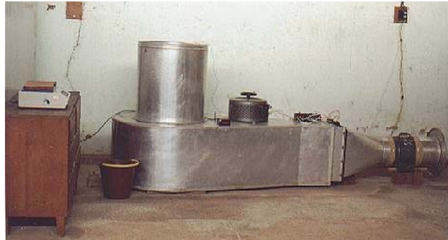
Figura 5 – Vista lateral do secador experimental utilizado para a secagem dos grãos (Esc. 1:43).
