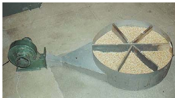
Figura 8 – Sistema de ventilação utilizado no processo de seca-aeração (Esc. 1:29).
