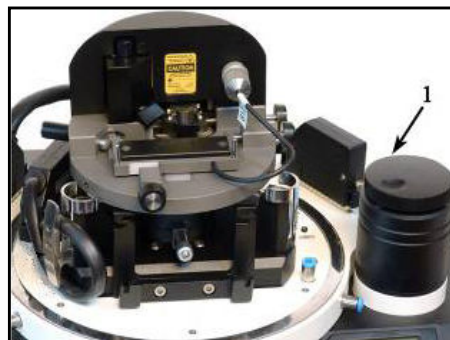
Figura 4.44: AFM em destaque o parafuso que afasta e aproxima a amostra da sonda. 57
