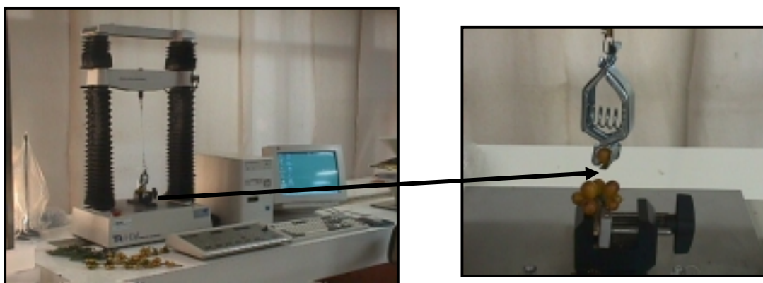
Figura 3 – Fruto de café seguro pela garra com molas no momento do desprendimento.
