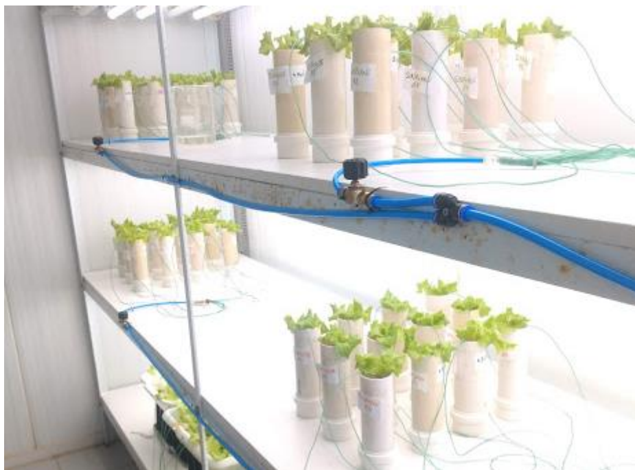
Figura 1. Sala de crescimento de plantas com condições controladas (sistema de aeração, temperatura de 25 \pm 2 °C, irradiância de 230 \mu\text{mol m}^{-2} \text{s}^{-1} e fotoperíodo luminoso de 16 horas).
