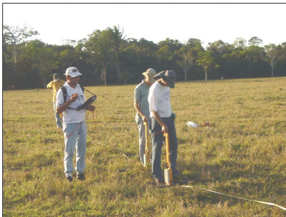
Figura 22. Obtenção dos perfis com GPR (Ground – Penetrating Radar).
