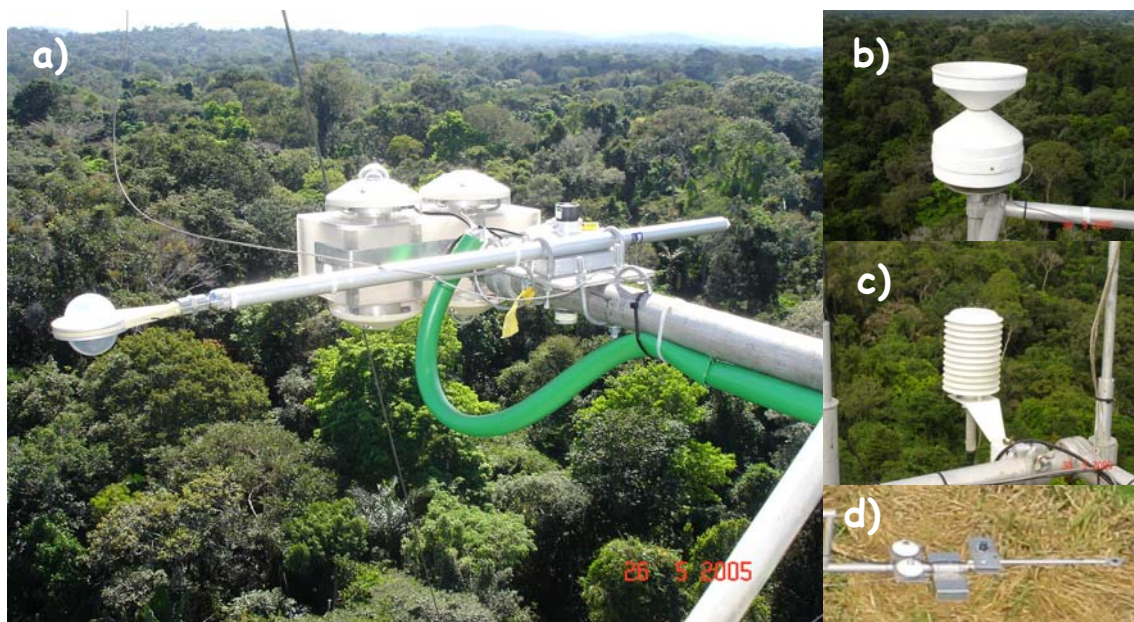
Figura 6. Sensores utilizados no estudo: a) Conjunto de sensores de radiação no sítio de floresta; b) Pluviômetro; c) Termohigrômetro e d) Conjunto de sensores de radiação no sítio de pastagem.
