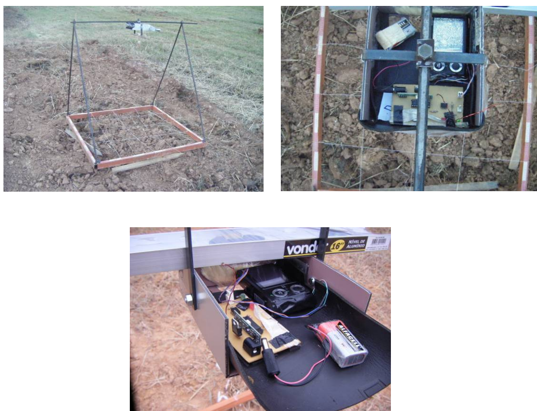
Figura 24. Estrutura de fixação para obtenção do par estereoscópico com detalhe da instalação da câmera e dispositivo receptor e nível multiplano.
