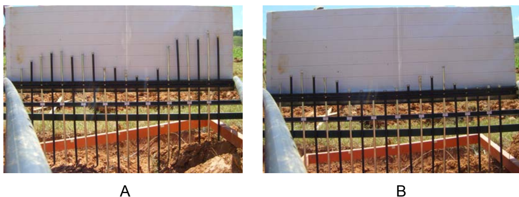
Figura 34. Leituras do perfilômetro na mesma parcela em duas posições, separadas de 0,25 m entre o posicionamento do perfilômetro em “A” e em “B”.
