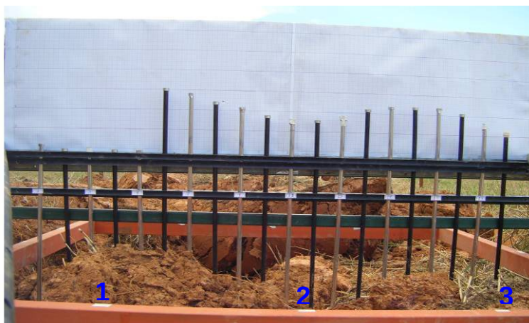
Figura 27. Perfilômetro de 20 hastes fixado sobre a estrutura metálica com as marcações das três posições (1, 2 e 3) de fixação.
