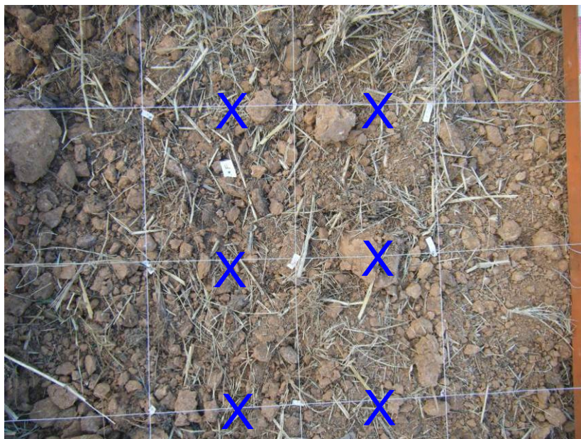
Figura 25. Imagem da parcela F na qual as etiquetas brancas fixadas no solo marcam os nove pontos de controle e os símbolos “X” localizam os seis pontos obtidos via estereoscopia.
