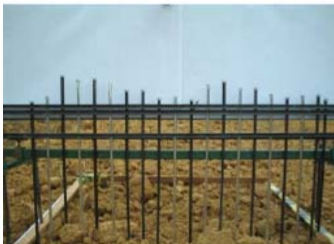
Figura 4. Perfilômetro de hastes empregado. Adaptado de Reis (2009).
