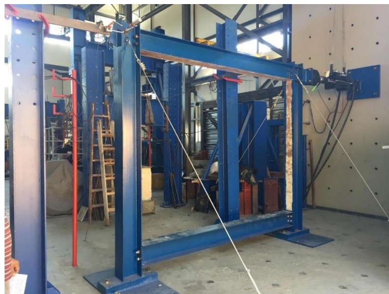
Figura 12 – Pórtico de aço associado ao sistema de carregamento antes do preenchimento com alvenaria.
