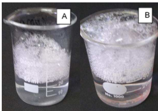
Figura 17 - Aspecto das espumas formadas pelo CPA (A) e CPA_S (B) em pH 2.
