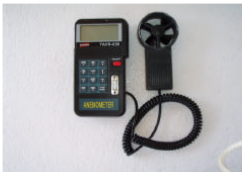
Figura 14 – Termo-anemômetro digital usado nas medições de velocidade do ar nas entradas e saídas do sistema.
