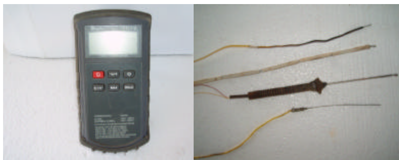
Figura 12 – Termômetro digital e termopares usados na medição de temperatura.
