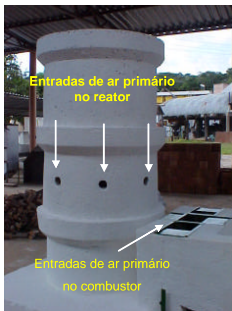
Figura 5 – Detalhes do gaseificador e das entradas de ar primário no reator e no combustor.
