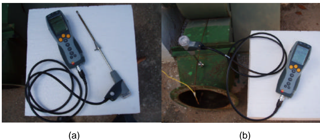
Figura 15 (a) – Analisador de gases de combustão; (b) Posicionamento da sonda durante a medição.
