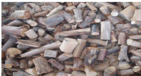
Figura 9 – Lenha de eucalipto usada no reator de gaseificação em consórcio com os briquetes.
