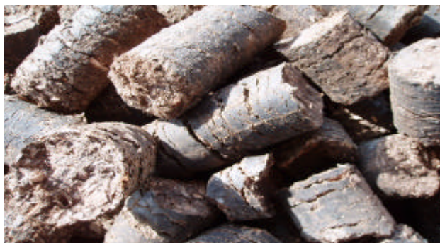
Figura 8 – Briquetes de casca de eucalipto, fracionados.
