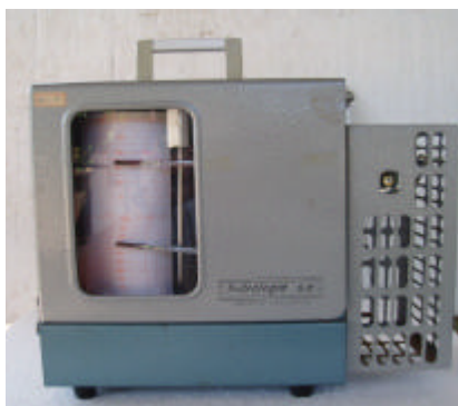
Figura 13 – Termo-higrógrafo usado para registro da temperatura e umidade relativa do ar ambiente.
