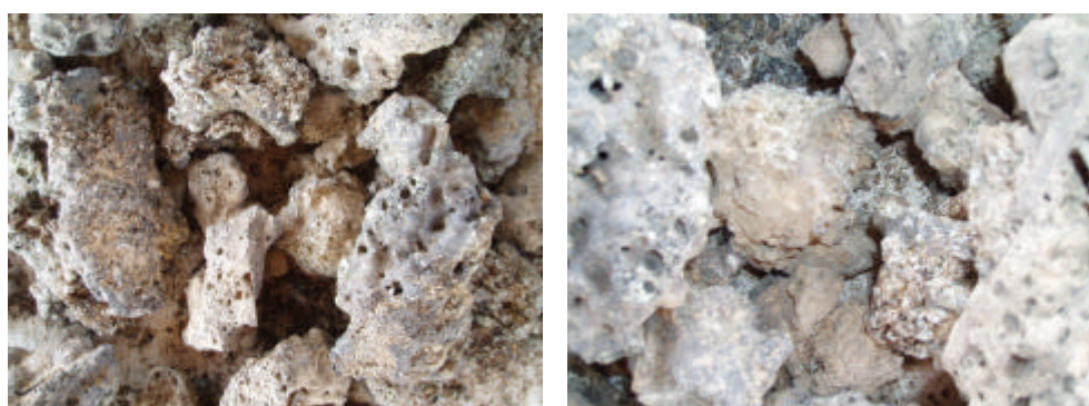
Figura 18 – Resíduos decorrentes da vitrificação das cinzas no reator.
