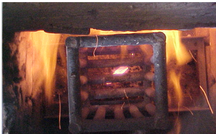
Figura 10 – Aspecto da chama durante a combustão dos gases.
