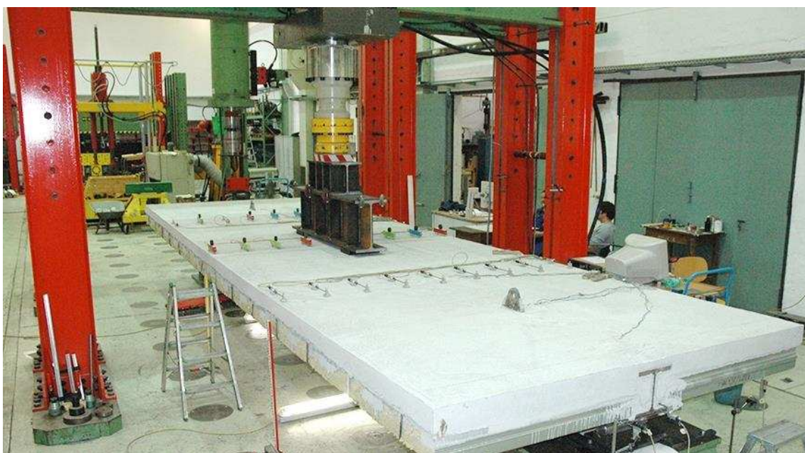
Figura 2.45. Teste de flexão nas vigas de slim floor do sistema CoSFB (BRAUN et al. , 2014).
