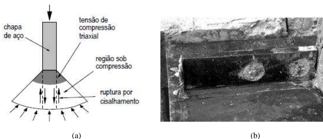
Figura 4.14. Condição de ruptura conector Perfibond com 22,0 mm de espessura, (a) modo de ruptura e (b) detalhe das aberturas após ensaio (USHIJIMA et al. , 2001 e VERÍSSIMO, 2007).
