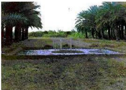
Figura 4 - Baterias de tensiômetros utilizadas para determinação da condutividade hidráulica do solo não-saturado em campo, utilizando o método da umidade proposto por LIBARDI et al. (1980).
