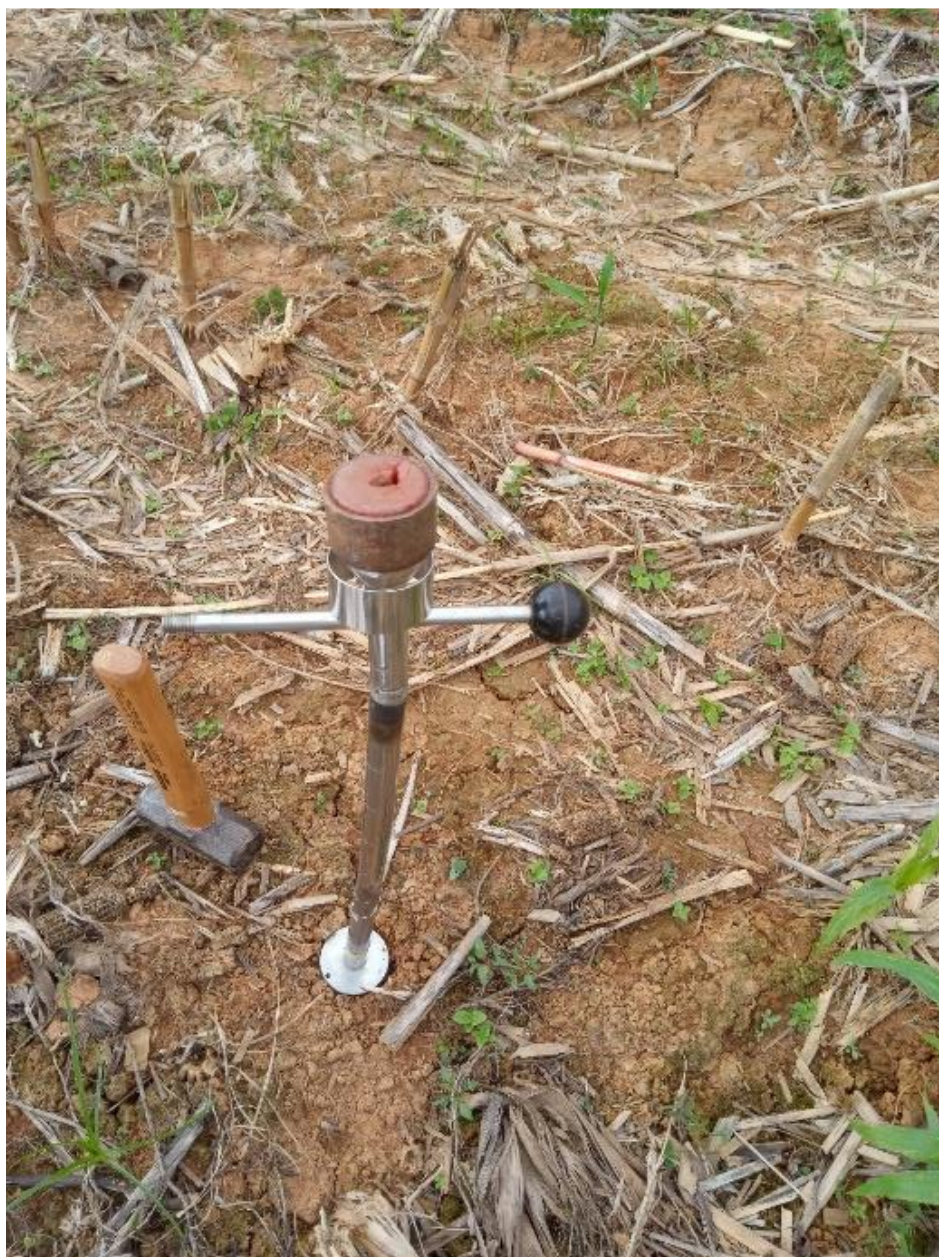
Figura 2. Trado manual utilizado para coleta de teor de água no solo e densidade.
