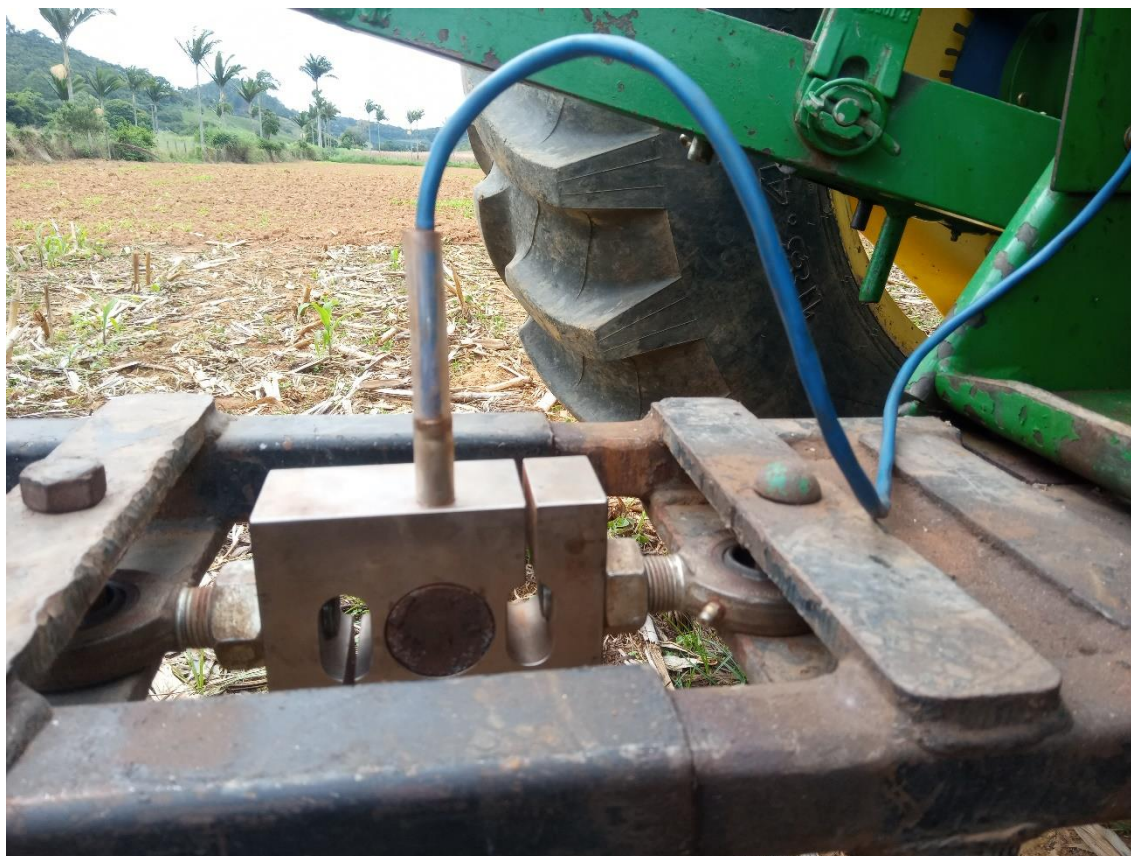
Figura 11. Célula de carga utilizada no experimento.
