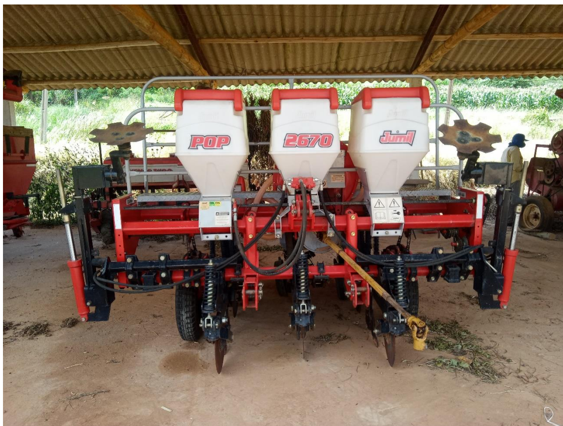
Figura 6. Semeadora-adubadora utilizada no experimento.
