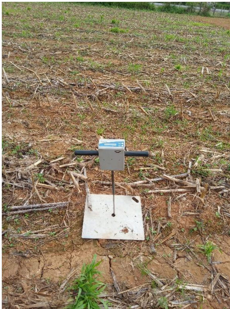
Figura 3. Resistência à penetração do solo da área experimental. Fonte: Raquel Santana.
