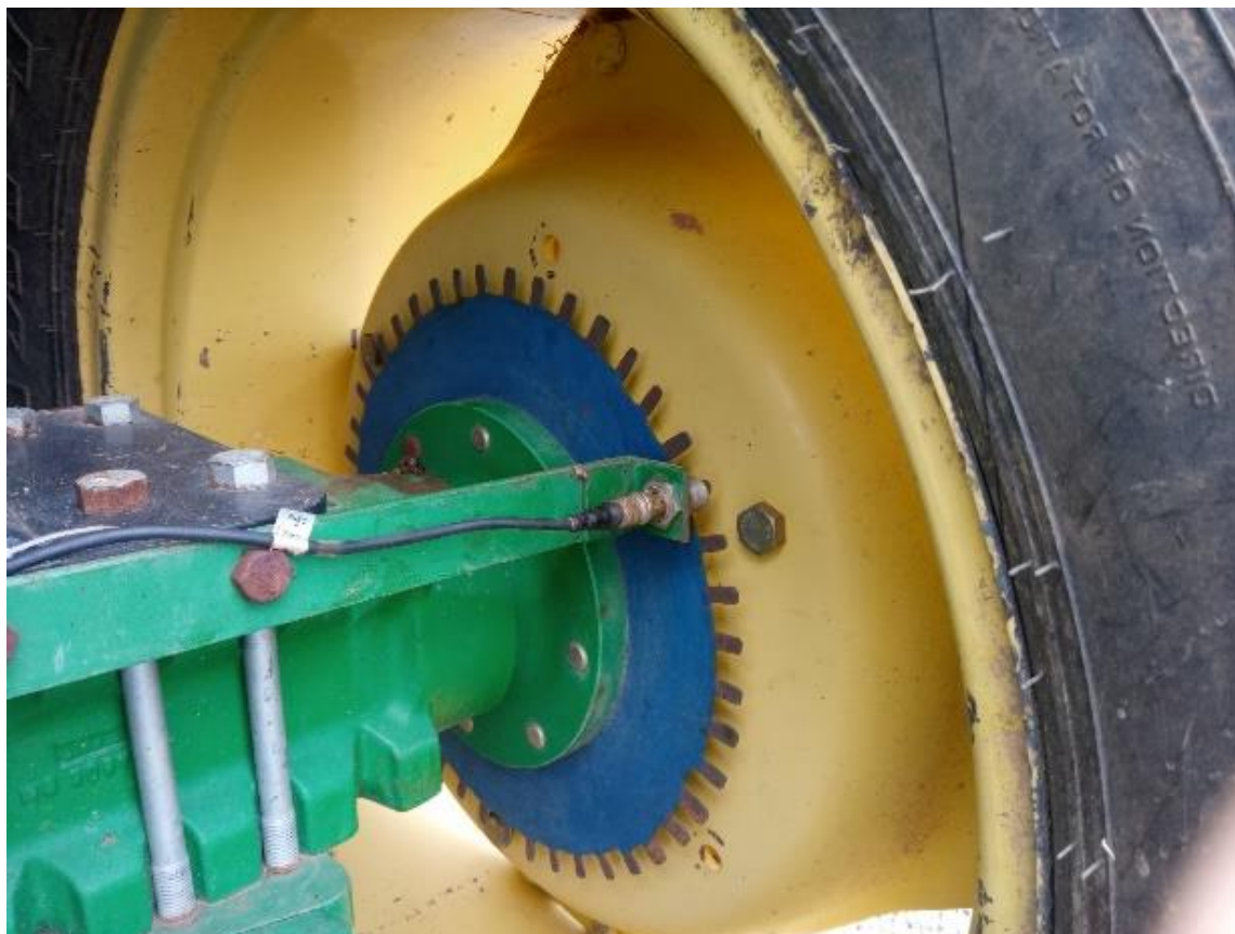
Figura 9. Transdutor indutivo utilizado no experimento.
