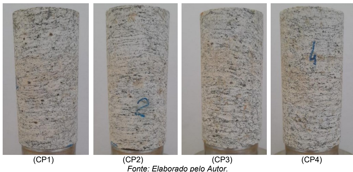
Figura 32 – CP's de Gnaiss W 3 com foliação perpendicular à carga de compressão axial.
