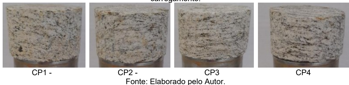
Figura 36 – Corpos de prova antes do ensaio BTS – Amostras W_3 com foliação paralela ao carregamento.
