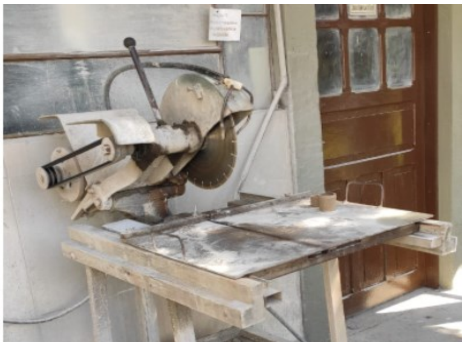
Figura 22 – Máquina de corte utilizada para a preparação das amostras.
