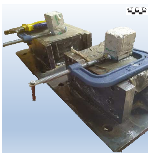
(a) Procedimento para a fixação da amostra na caixa inferior do ensaio de cisalhamento direto
