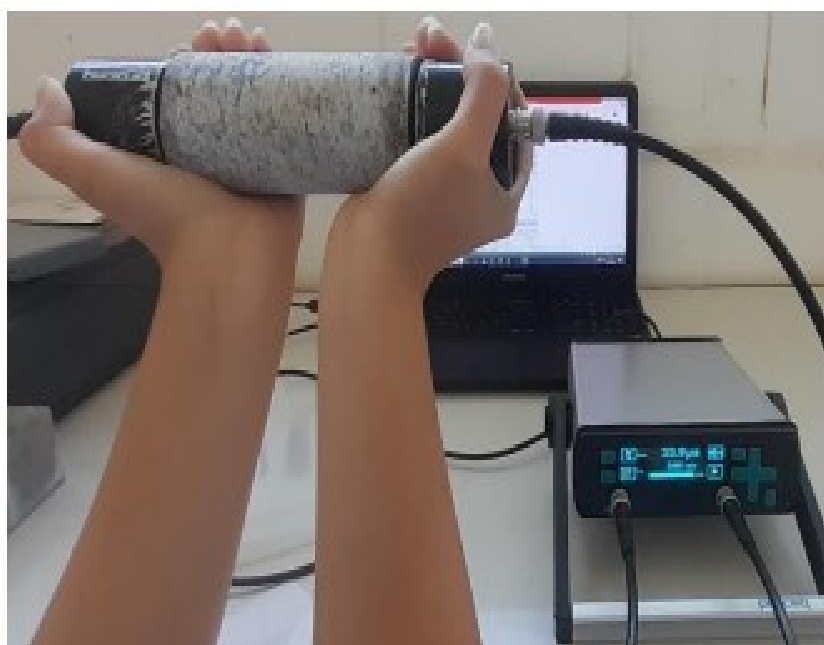
Figura 38 – Realização do ensaio de velocidade de propagação de ondas em amostras cilíndricas
