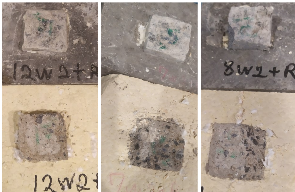
Figura 108 - Amostras W2 –Superfície Muito Rugosa, JRC 12 a 14, após ruptura.
