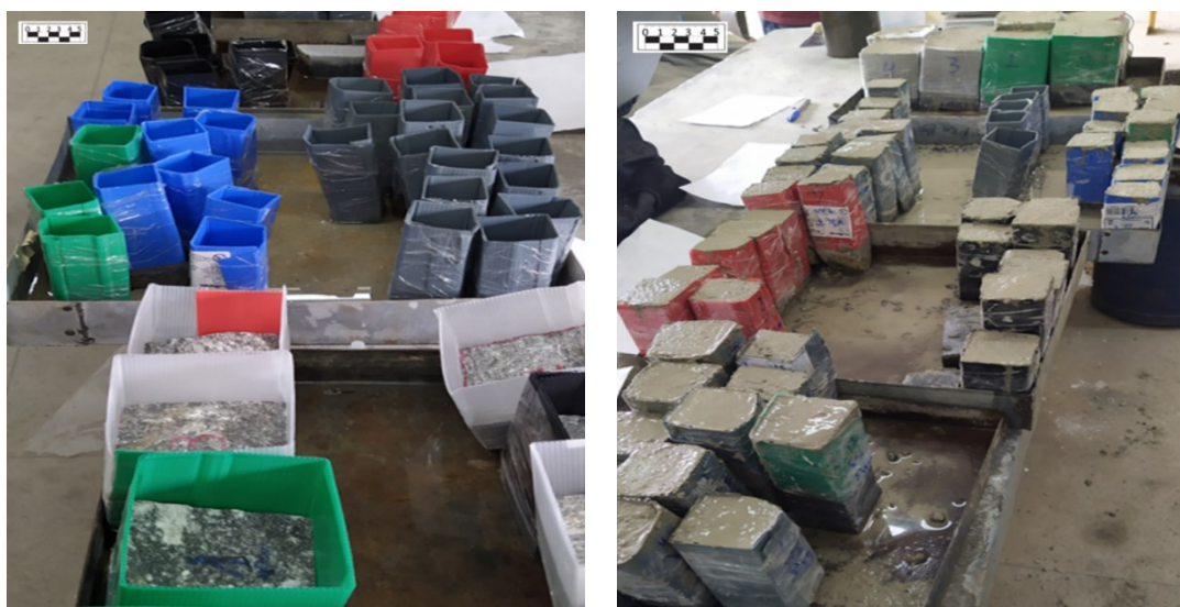
Figura 42 – Preparação das amostras para a concretagem
