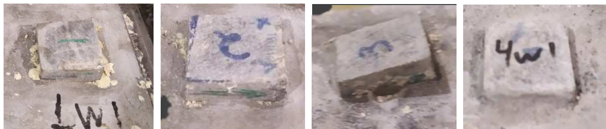
Figura 78 - Amostras w_1 – Superfície lisa pós ruptura
