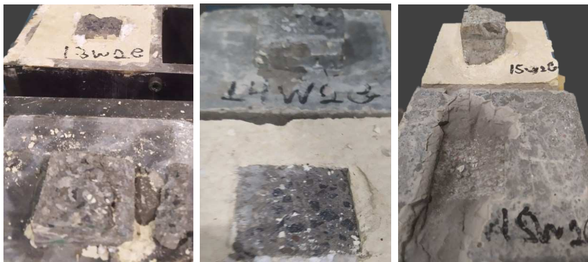
Figura 89 - Amostras W2 – Graute-Rocha – Superfície lisa após ruptura.
