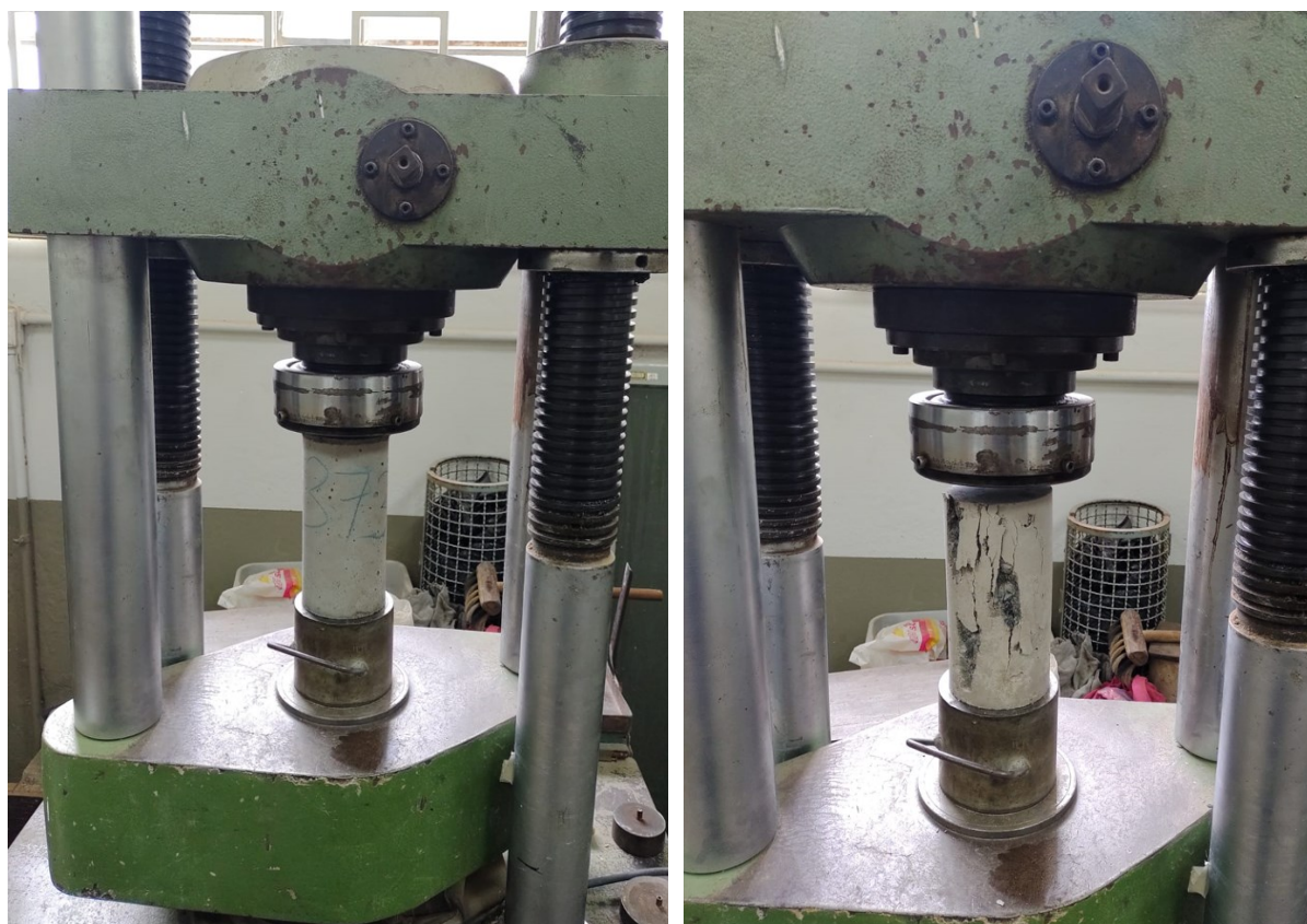
Figura 28- Ensaio Resistência à Compressão Uniaxial do Concreto Convencional (à esquerda) e do Graute (À direita).
