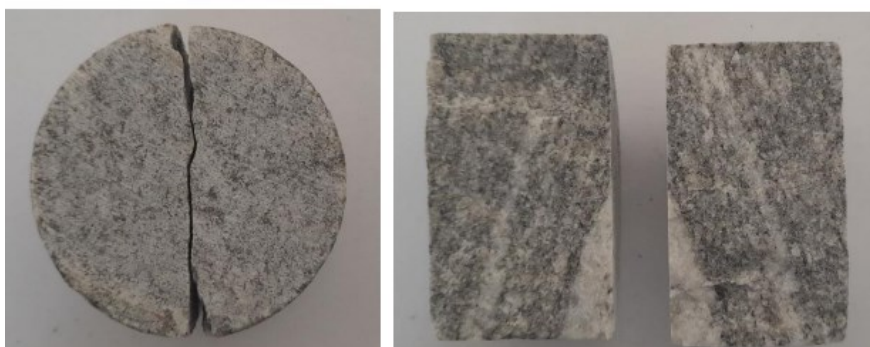
Figura 69 - Corpo de prova W_1 com a foliação perpendicular após a ruptura.
