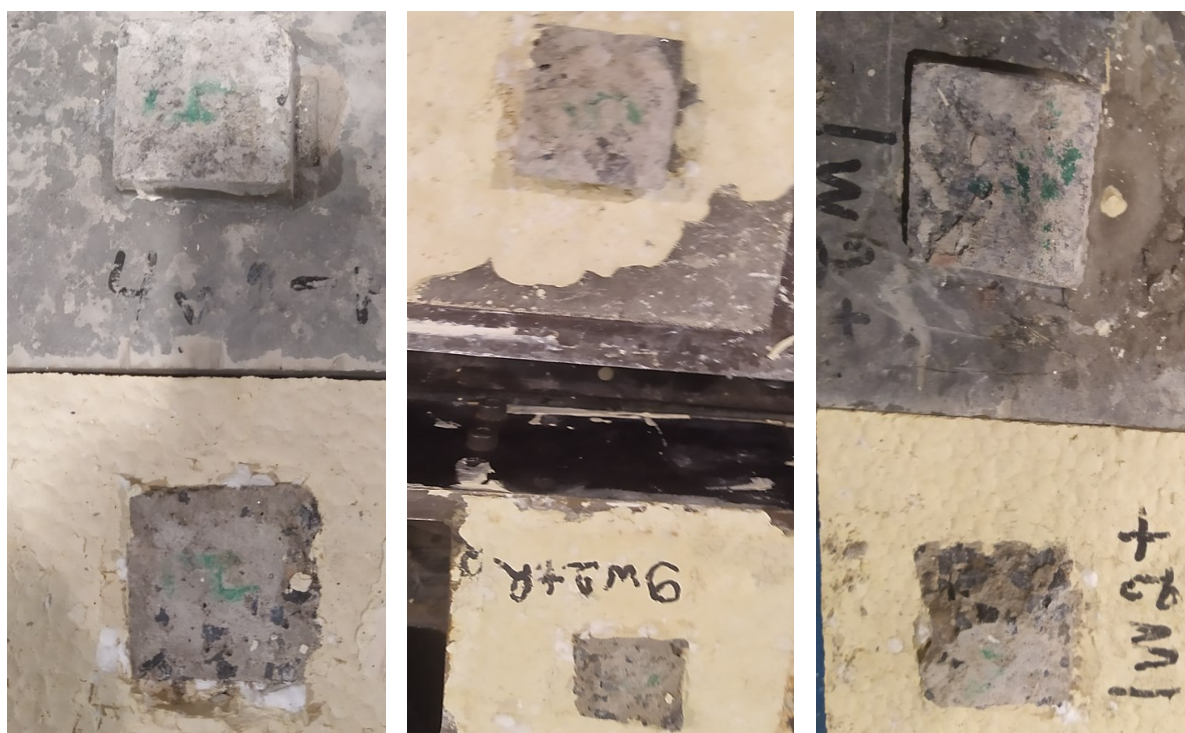
Figura 103 - Amostras W2 –Superfície Medianamente Rugosa, JRC 8 a 10, após ruptura.
