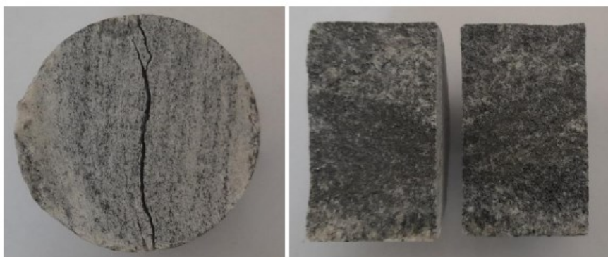
Figura 68 - Corpo de prova W_1 com foliação paralela após a ruptura.
