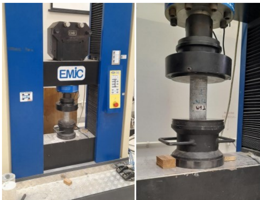
Figura 27 - Prensa hidráulica e execução do ensaio de compressão uniaxial - Rocha. Prensa hidráulica, da EMIC, modelo MUE, com capacidade de 100 tf.
