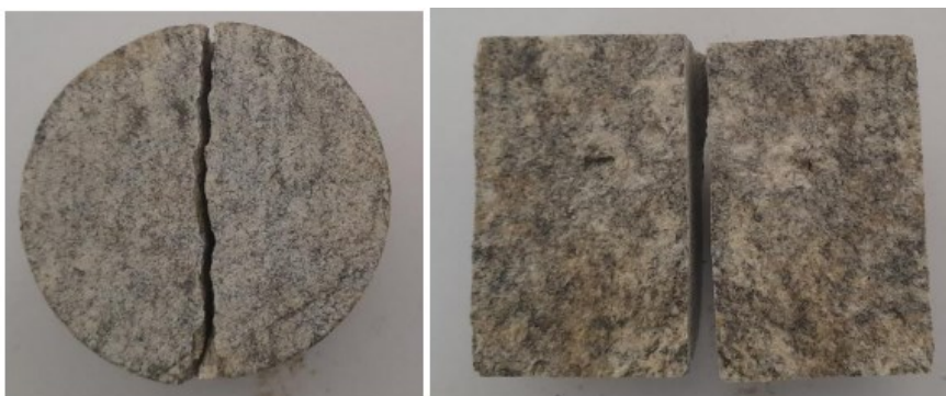
Figura 70 - Corpo de prova W_2 com foliação paralela após a ruptura.
