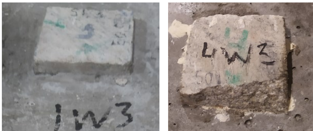
Figura 86 - Amostras W_3 – Superfície lisa pós ruptura
