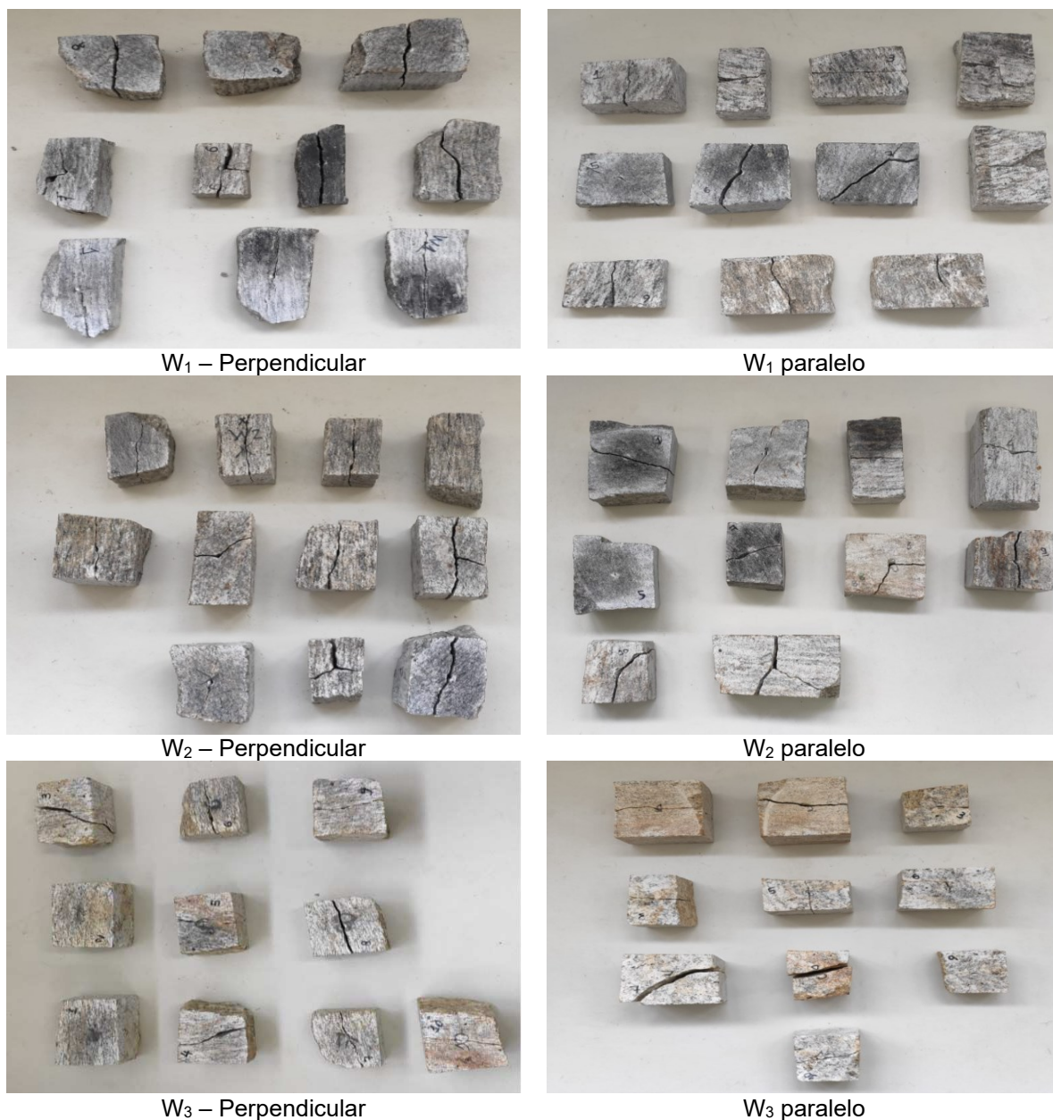
Figura 37 - Amostras W_1 , W_2 e W_3 ensaiadas (PLT) com foliação (a) perpendicular e (b) paralela em relação ao carregamento.
