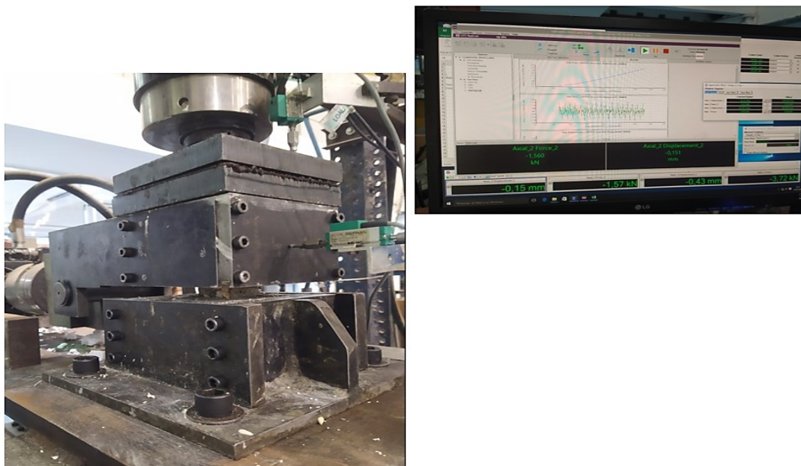
Figura 46 – Ensaio de cisalhamento direto durante sua execução.
