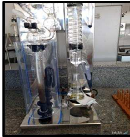
Figura 2. Processo de destilação usado na caracterização de proteínas.
