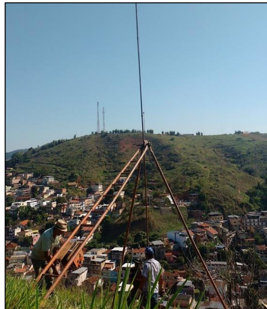
Figura 9. (a) Ilustração do Ensaio SPT; (b) Representação do Ensaio SPT em campo realizado em Além Paraíba (MG).
