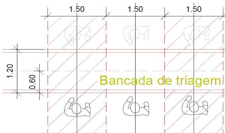
Figura 6 - Espaçamento entre triadores em bancada estática de triagem.
