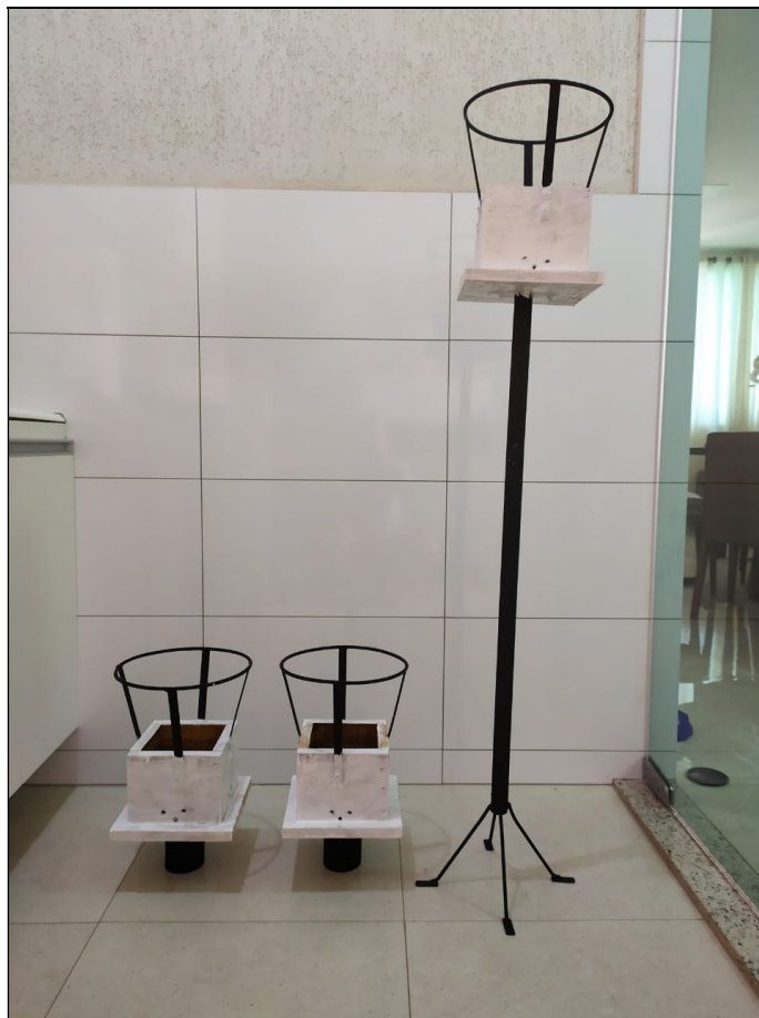
Figura 4 - Estrutura de proteção e fixação dos coletores construídos com madeira e metal
