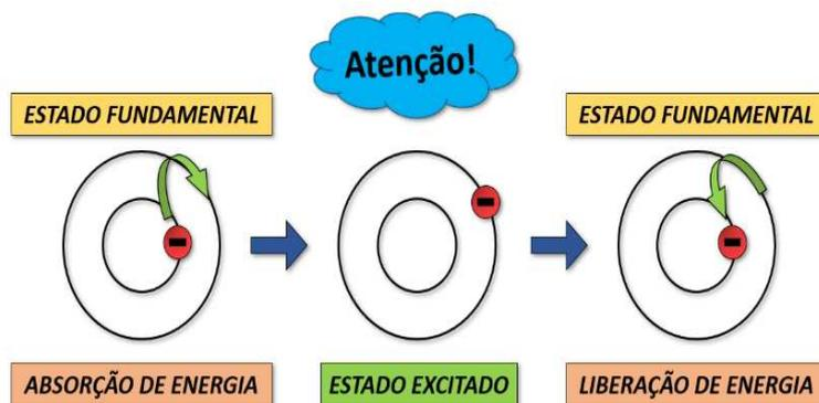
Representação de um modelo de átomo e a ocorrência da transição eletrônica ao absorver a luz: salto de um nível energético mais alto e em seguida o retorno do elétron ao estado fundamental. Fonte: <https://www.passeidireto.com/pergunta/68229243/g-1-cftmg-2007-em-fogos-de-artificio-observam-se-as-coloracoes-quando-se-adicion>
