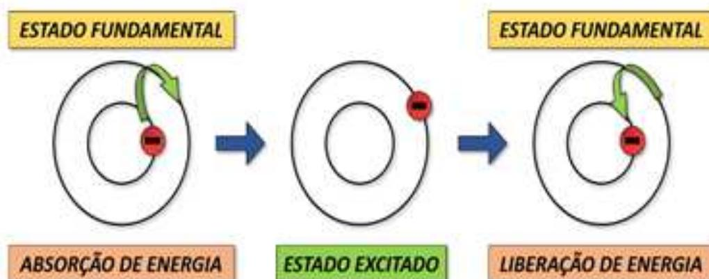
**Figura 4:** Representação de um modelo de átomo e a ocorrência da transição eletrônica ao absorver a luz: salto de um nível energético mais alto e em seguida o retorno do elétron ao estado fundamental.
