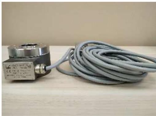
Célula de carga, da HBM, modelo C6A, com capacidade de 200 kN.
