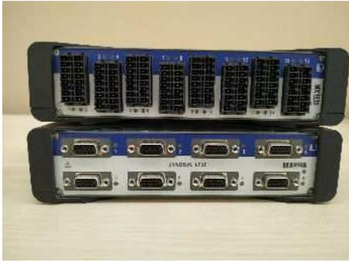
Sistemas de Aquisição de Dados (SAD), modelos QuantumX MX1615 e MX840A.
