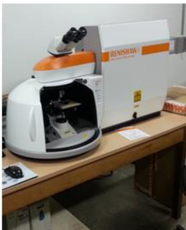
Figura 2. Espectrômetro Raman InVia da Renishaw utilizado nas análises (Foto: Laboratório de espectroscopia Raman, Departamento de Física – UFV/ http://www.posfisica.ufv.br ).
