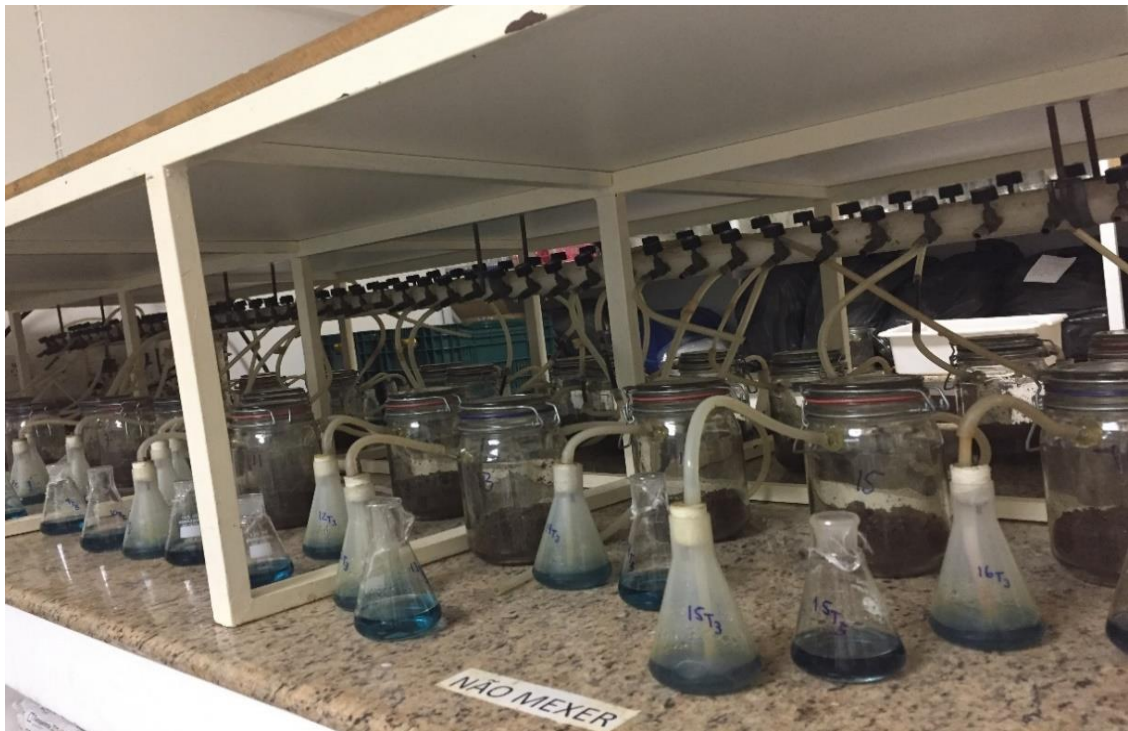
Figura 3 – Sistema para avaliar a volatilização da \text{NH}_3
