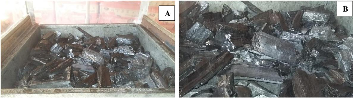
A: Recipiente utilizado para armazenar o carvão vegetal durante o ensaio; B: Amostra de carvão vegetal durante o ensaio de aspersão de água.
