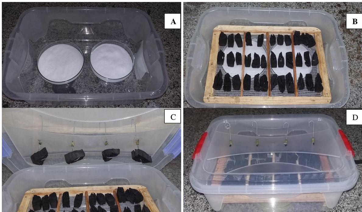
A: Solução salina utilizada no condicionamento do carvão vegetal; B: Amostras de carvão vegetal dispostas na caixa de condicionamento; C: Carvão vegetal e hastes metálicas para fixação de corpos de prova no topo do recipiente; D: Caixas de condicionamento das amostras.
