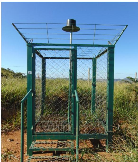
Figura 18 – Pluviógrafo modelo Rain Wise usado para medida da precipitação em aberto na área de mineração no município de São Sebastião da Vargem Alegre, MG.
