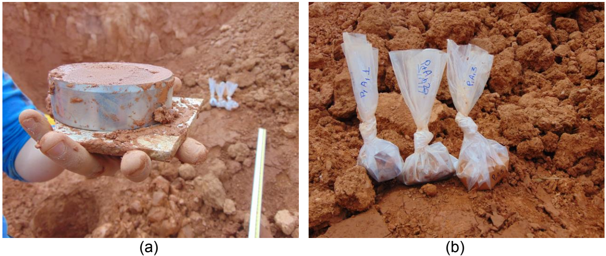
Figura 22 – (a) Anel metálico com molde do solo; e (b) embalagens vedadas a serem levadas ao Laboratório de Mecânica dos Solos do Departamento de Engenharia Civil da Universidade Federal de Viçosa (LMS-UFV).
