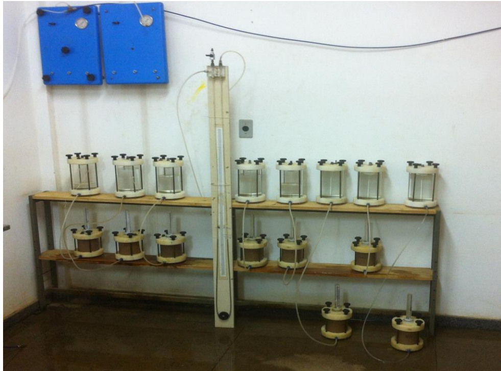
Figura 26 - Visão geral do equipamento utilizado para o ensaio de permeabilidade, Laboratório de Mecânica dos Solos do Departamento de Engenharia Civil da Universidade Federal de Viçosa (LMS-UFV).
