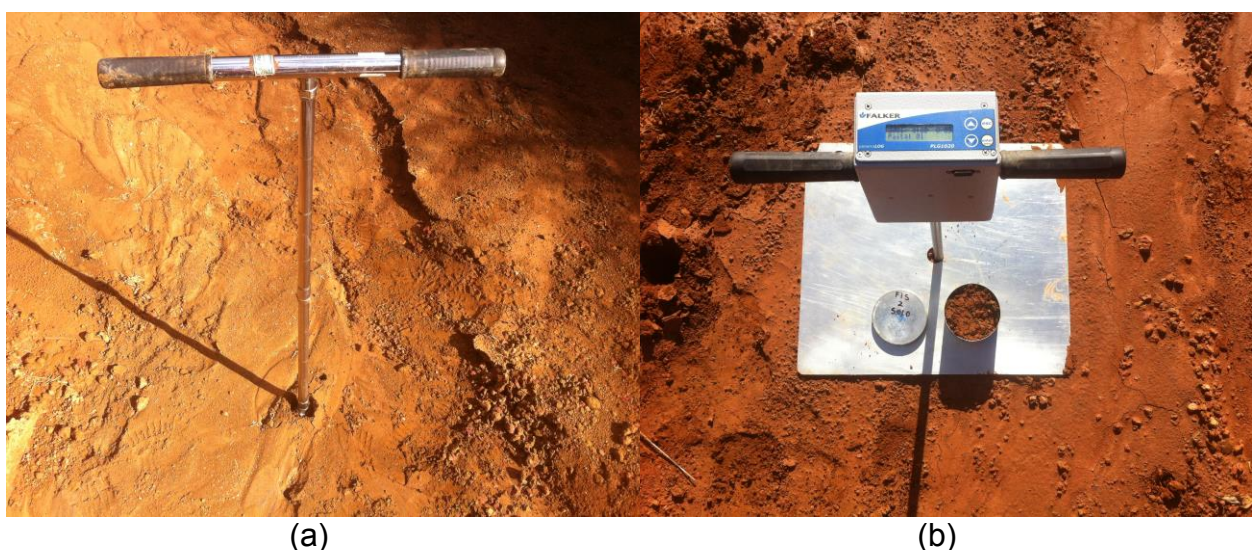
Figura 27 – (a) Coleta de amostra de 0 -10 cm e 10-20 cm para determinação do teor de umidade; e (b) realização dos testes de compactação com o penetrômetro eletrônico em Maio 2017.
